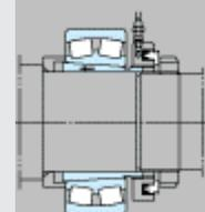
(d) Removal by use of locknuts
